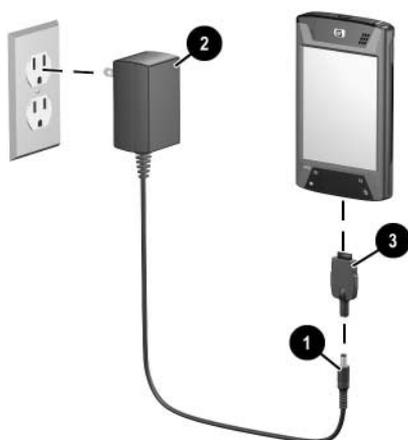
4. Pocket PCの前面にある電源ボタンランプがオレンジ色に点灯したら、本体が完全に充電されたため、ACアダプタを抜くことができます。充電されたバッテリーが完全に充電されるまでの時間は約4時間です。
