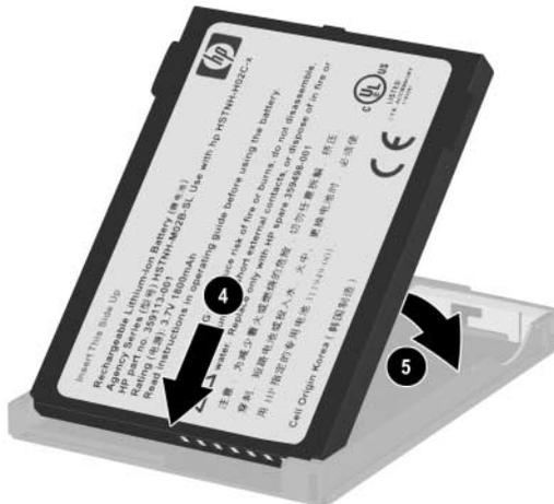
4. Pocket PCの背面のカバーにバッテリーを挿入して、バッテリーの下部をカチッと音がするまで所定の位置にスライドさせます⑥。
