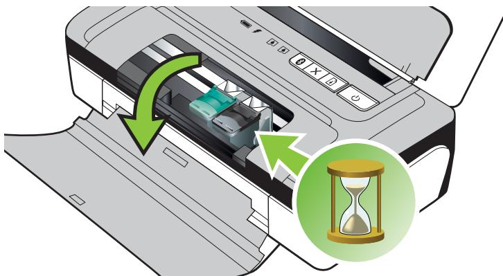
3. インク ホルダが停止して静かになってから、インク カートリッジのラッチを持ち上げて、インク カートリッジを解除します。
