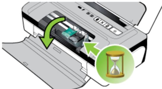
3. インク カートリッジのラッチを持ち上げて開き、ホルダーからインク カートリッジを静かに取り外します。
