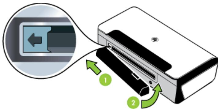
2. カチッという音がするまで、バッテリをバッテリスロットに押し込みます。
