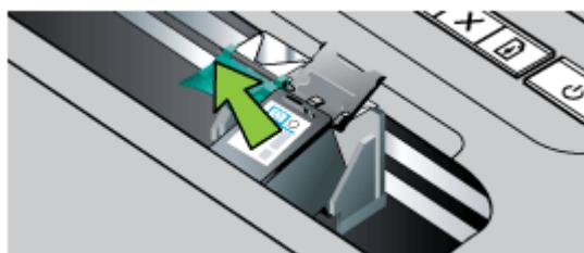
4. 取り外した古いインク カートリッジと同じ角度で、新しいインク カートリッジをホルダーに挿入します。ラッチとインク
