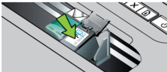
5. インク カートリッジのラッチを閉じます。カートリッジが正しく挿入されている場合は、ラッチを閉じるとカートリッジが収納部に引き込まれます。ラッチを押してみて、ラッチが平らになっていることを確認します。
