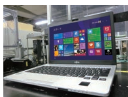
液晶ディスプレイの開閉動作を繰り返し、破損などがないか、耐久性のチェックを行います。
