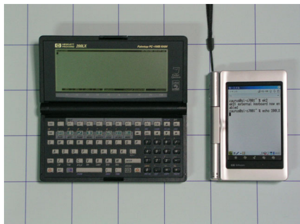
図 10 HP200LX を外部キーボードとして使う
