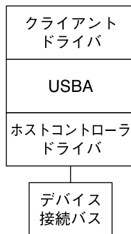
図 7-2 Solaris USB アーキテクチャー (USBA)
