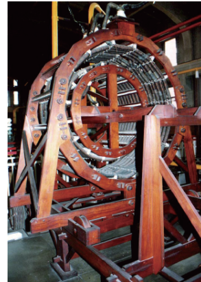
図 8.14 可変インダクタの例. 内部のコイルが前後に可動し、その周りのコイルとの結合の度合い ( k の値) を変えることにより M を変えている [5].
