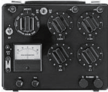
図 5.13 275597 携帯用ホイートストーンブリッジ (横河メータ& インストルメンツ株式会社) [1]. 1\ \Omega \sim 10\ \text{M}\Omega までの広範囲を測定可能 (有効数字 4 桁).
