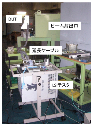
図 8: 中性子照射実験の様子
