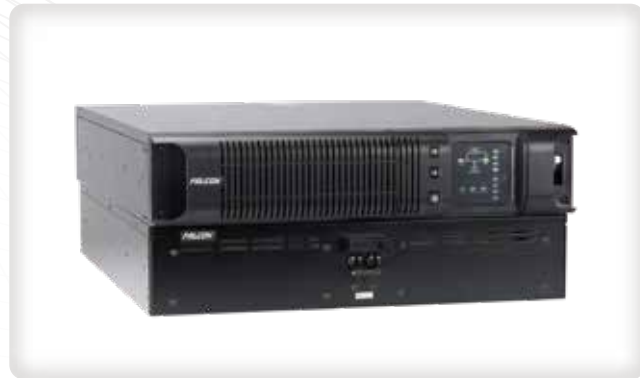
UPS Model: SSG3KRP-1 ◇ 入力: 単相 50/60Hz 80VAC~138VAC ◇ UPS: バッテリー12VDC/5A, 拡張可 ◇ 出力: 単相 50/60Hz 100, 110, 115, 120VAC, 2100Watt ◇ 動作温度: -30°C~+60°C 拡張温度対応UPS
