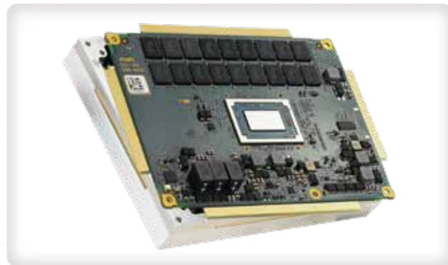
AMD Model: CB71C ◇ AMD V1000 APUシリーズ ◇ ~32GB DDR4 ◇ 4コア, ~3.35GHz AMD APU搭載 耐環境性 COM Express CPUカード
