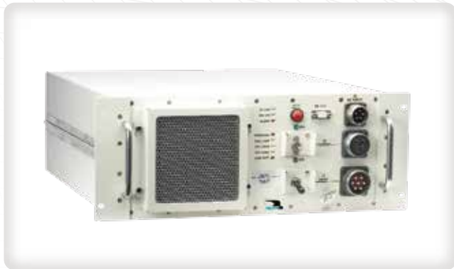
コンバーター / UPS Model: ED4-5000RM-3 シリーズ ◇ 入力: 三相 Y 47~450Hz, 115/200V, 16A/φ ◇ UPS: バッテリー搭載オプション ◇ 出力: 単相 50Hz, 60Hz, 400Hz(製品別) 3500Watt 耐環境性 周波数/位相コンバーター
