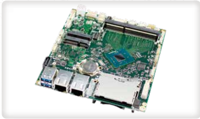
Intel Model: VX-6020 ◇ 125 × 140mm ◇ DDR3 SO-DIMM memory ◇ ECC ◇ 単一電源動作(ワイドレンジ12V) E3800ファミリー搭載 組み込み向けCPUボード FAN L JPN
