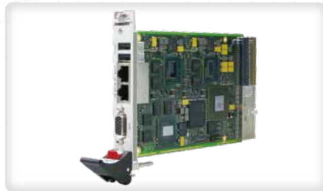
Intel Model: F75P ◇ Intel Atom × 2 ◇ Intel Atom × 1 ◇ 1.6GHz, 512MB DDR2 ◇ 1.6GHz, 1GB DDR2 Atom搭載 鉄道用セーフコンピュータ
