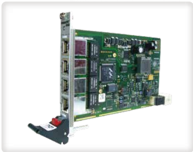
スイッチ Model: G303 ◇ Gigabit Ethernet × 16 ◇ EN50155 class Tx ◇ M12 ◇ Unmanaged 耐環境性イーサネットスイッチ
