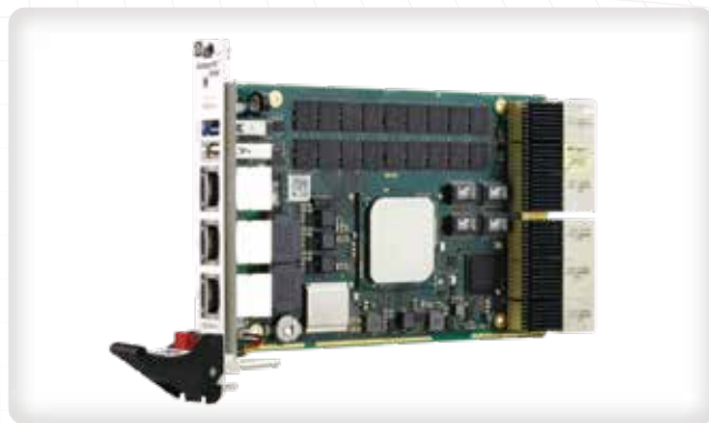
Intel Model: G25A ◆ Intel Xeon D-1500 ◆ 4~16コア ◆ ~32GB DDR4 Intel Xeon搭載 CompactPCI Serialボード
