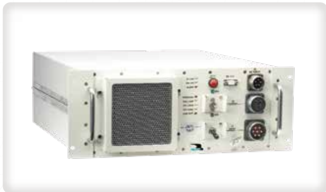
コンバーター / UPS Model: ED4-5000RM-SP シリーズ ◇ 入力: 単相3線 SplitPhase 47~450Hz, 240/120V, 20.9A/φ ◇ 出力: 単相 50Hz, 60Hz, 400Hz(製品別) 3500Watt ◇ UPS: バッテリー搭載オプション 耐環境性 周波数/位相コンバーター
