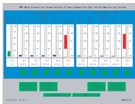
画面 1 バークラフ (傾斜・振動・回転) Screen 1 Bargraph (Inclination・Vibration・Propeller speed)
