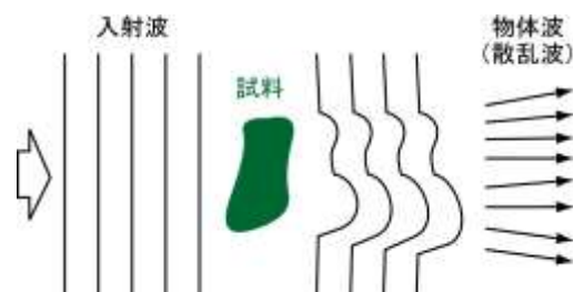
図 1 「物体波」の概念図。試料に波 (コヒーレントなビーム) を当てて相互作用した後の波が「物体波」である。コヒーレント回折イメージングでは、遠方場での「物体波」であるコヒーレント回折パターンを測定し、試料背面の「物体波」 (位相コントラスト) を定量的に可視化する。
