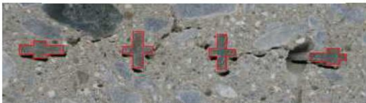
コンクリートを打設したドーナツ型スペーサの切断面
