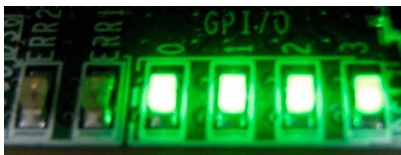
図 4a: SATA-II HDD が接続されたときの正常な LED 点灯状態
