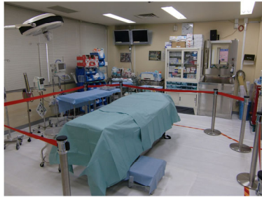
図2-4-A-2 処置室の養生の参考例 (撮影場所: 国立研究開発法人 量子科学技術研究開発機構) ・床全体にポリ塩化ビニルシートを貼る。 ・処置室は医療用防水シートで覆われている。 ・処置室の中心部はペルトパーテーションにより区切られている。
