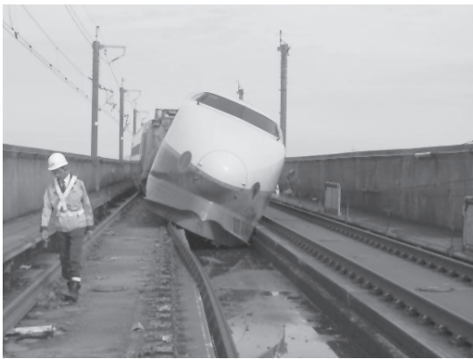
写真7 脱線した上越新幹線(2004年新潟県中越地震)
