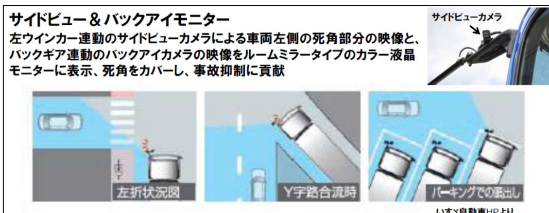
図 3-2-6 カメラモニタリングシステムを活用した大型車の視野拡大
