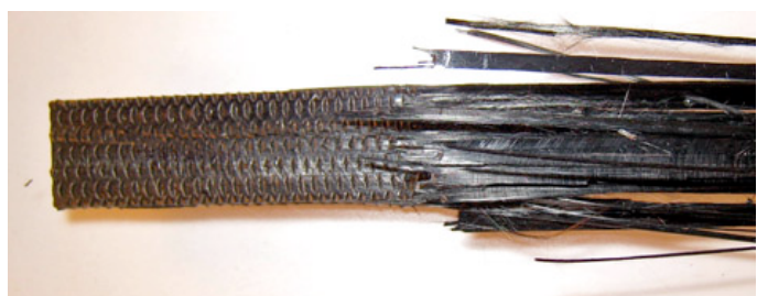
図4 金属製チャックで直接に掴む（強度は低めの破壊モード）
