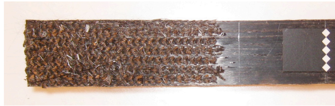
図2 抜けの生じた試験片のチャック部（引張り負荷失敗）
