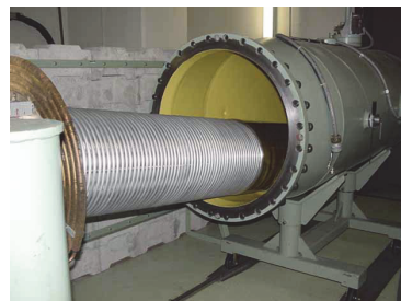
図2 崩壊した加速器
