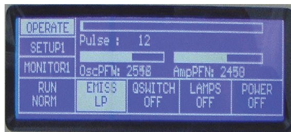
図 6. RUN LP 後、上の画面で 20 分待機し RUN NORM を押す。
