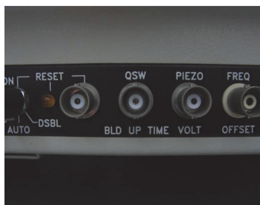
図 8. 電圧測定箇所 (Q-SW) 2.18V 程度を示す。
