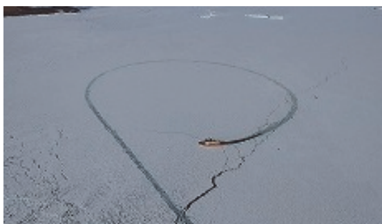
Fig.11 水中旋回性能試験の航跡空撮
