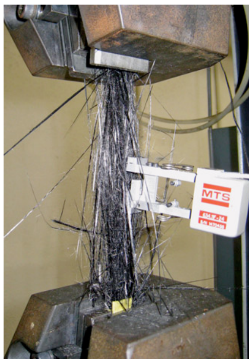
図1 一方向炭素繊維強化プラスチック複合材料の典型的な引張り破壊の様子
