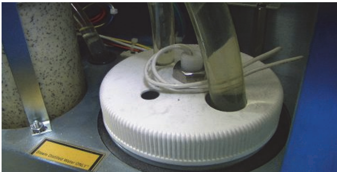
図 9.ユニットカバー内の冷却水タンク
