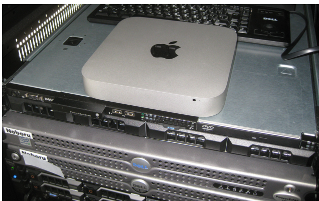
図2. Mac mini Server と既存のサーバー(1U)との比較
