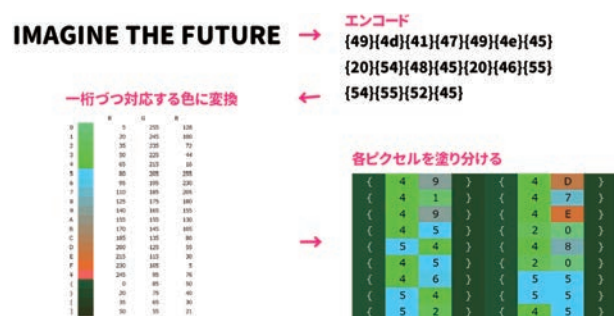
図 4: テキストを画像ビットマップに埋め込む処理
