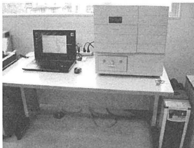
図2 極微弱発光検出分光システム
