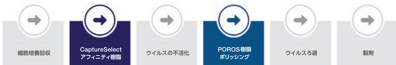
図1. 本ワークフローは、バイオ医薬品開発の典型的なダウンストリームのプロセスを示しています。CaptureSelect および POROS 樹脂は、キャプチャーおよびポリッシングの両精製ステップに使用できます。
