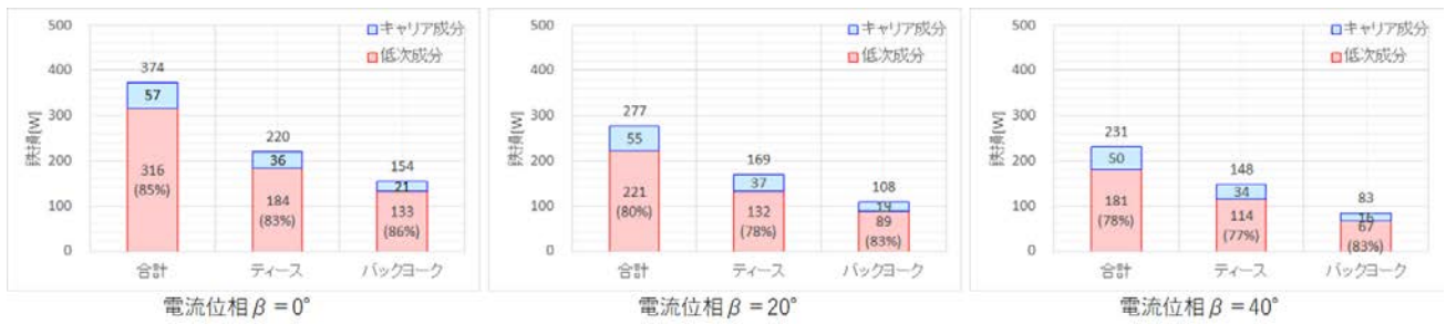
図 3.4.21 低次成分とキャリア成分の鉄損分離結果 (キャリア周波数 5kHz)
