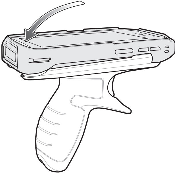
図 165 デバイスを回転させてトリガ ハンドルに取り付ける
