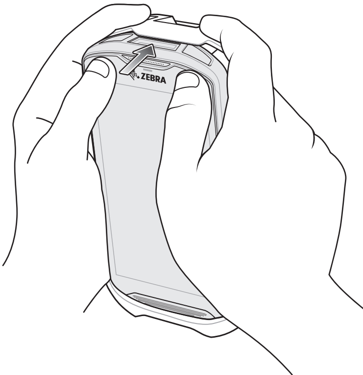
図 162 デバイスをブーツに押し込む
