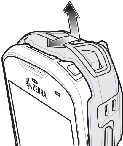
図 133 ブーツをデバイスの上まで持ち上げる
