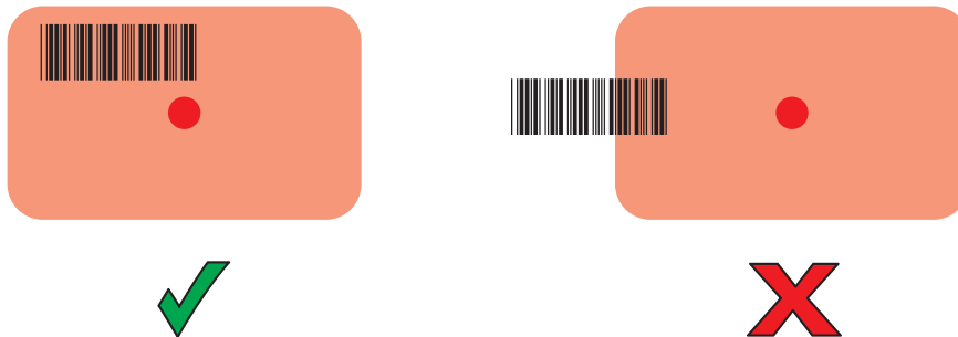
図 120 DS3678-SR ピックリスト モード: 複数のバーコードが照準パターン内にある場合
