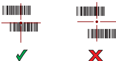
図 117 RS507/RS507X ピックリストモード：複数のバーコードが照準パターン内にある場合
