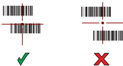
図 114 RS6000 ピックリスト モード: 複数のバーコードが照準パターン内にある場合
