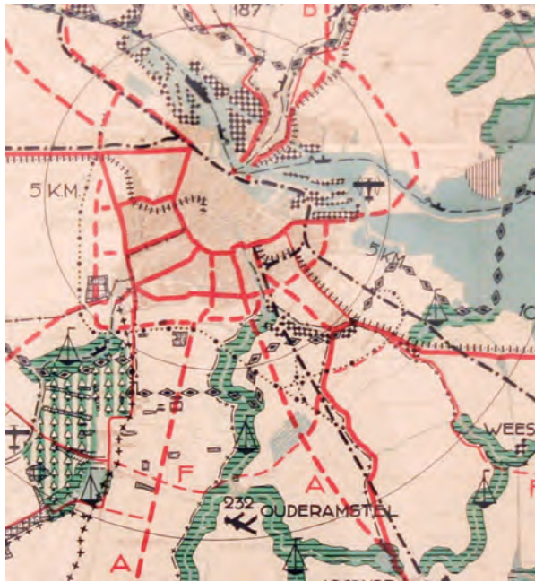
図 3.5. ファン=エーステレン, 都市分析図, 部分拡大。複数の「ハッチング」のパターンが異なる土地区分を示すために用いられている。また下中央部に「歩行者」のシンボルが道に沿って配置されている。(出典:『世界の表象:オットー・ノイラートとその時代』2007)
