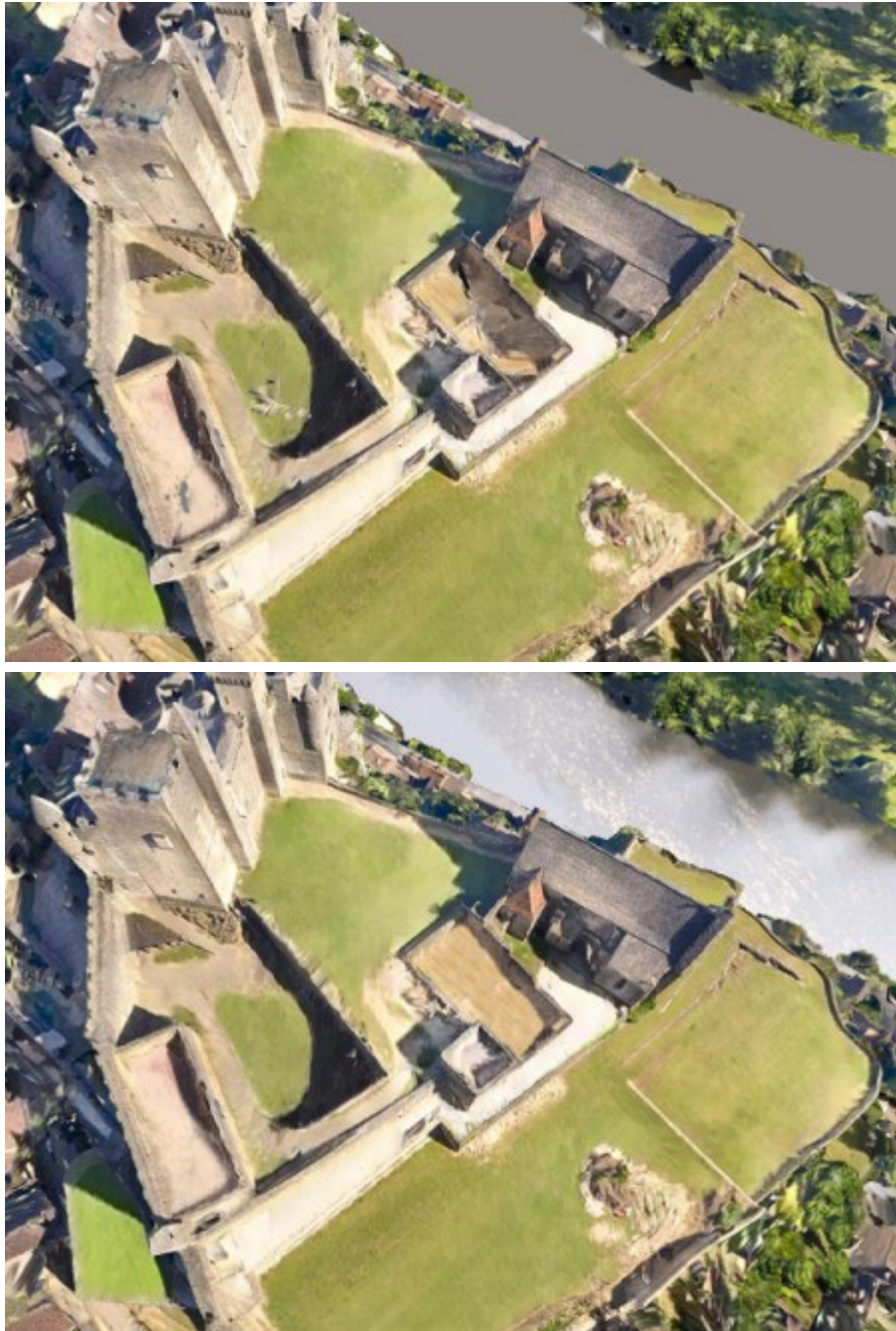
図 106: テクスチャとジオメトリの両方を修整した例(水面)
