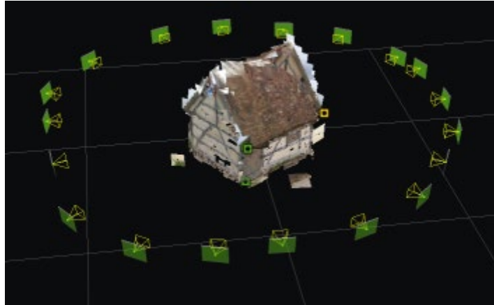
図 36: 生成されたタイポイントと、対応するスプラットの表示
