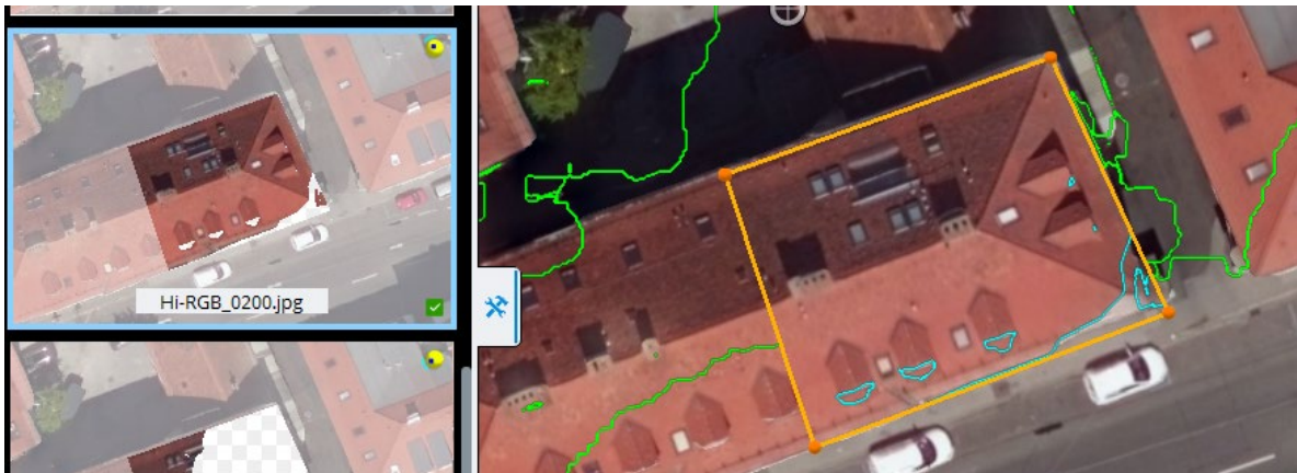
図 76: 緑の線は、オルソフォトモザイクの現在のシームラインです。水色の線は、ポリゴン内に選択した画像を適用した場合に導入される新しいシームラインです。
