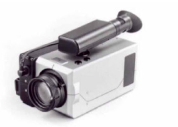
図 6 8 試作6号機 (1984年8月: 撮影モード識別アルゴリズム)
