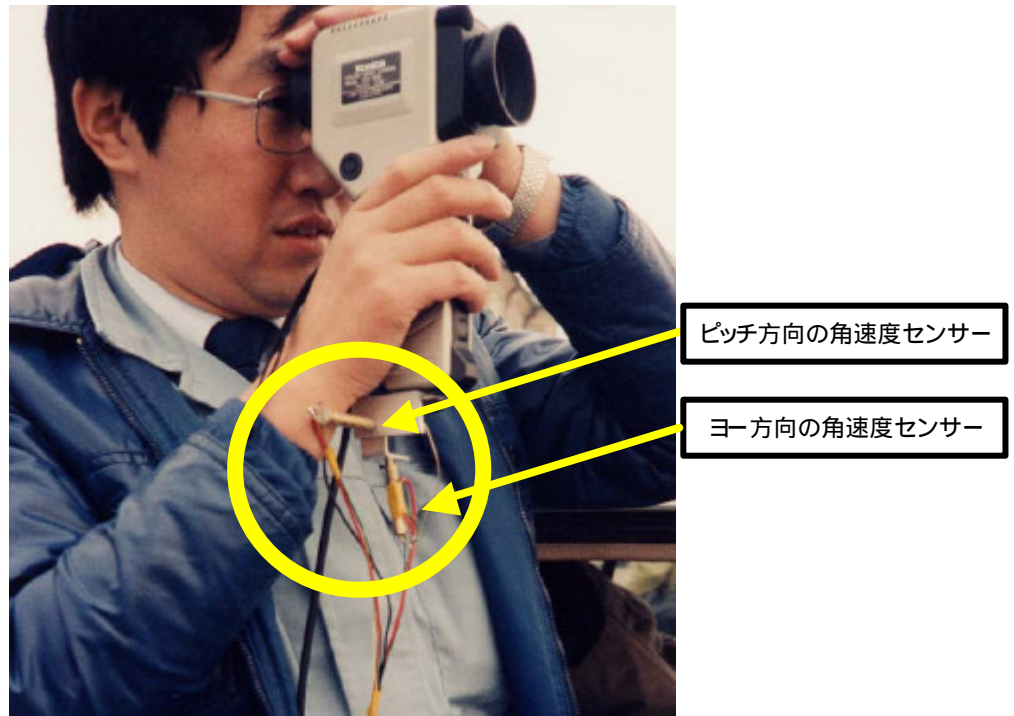
図 1 9 発生した手振れ量の測定実験
