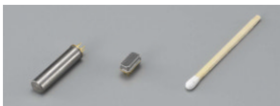
図 8 4 振動帰還音叉型振動ジャイロの斜視図（左：1987年、右：2003年）
