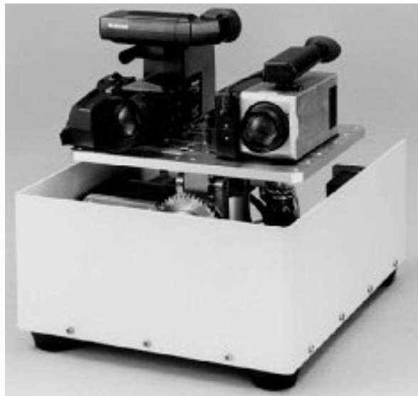
図 6 3 手振れ発生装置
