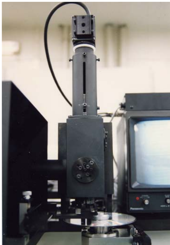
図 2 2 7 B C A 記録装置の光ヘッド部
