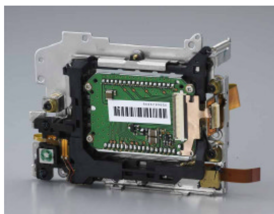
図 1 0 0 撮像板駆動部の外観 ( 裏面 )
