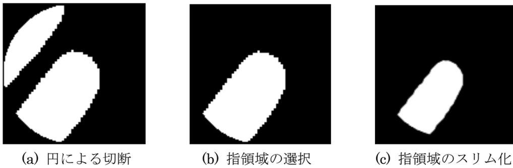
図 5-7 指の回転軸取得のための処理
