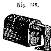
図149 [314章] 金属亜鉛製造の蒸留器(粘土製マッフル)
