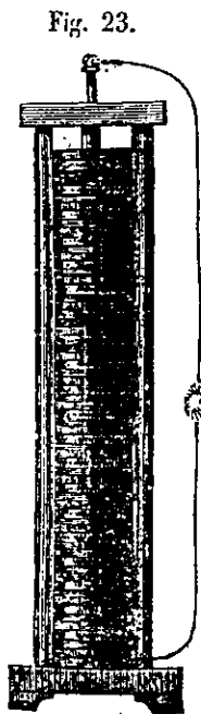
図23 [55章] 試とはしていないが、ボルタ柱の記載。
