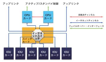
CSCのデータロックステップ・アーキテクチャは、同一のI/Oを維持しながら、経時的にプロセッサアーキテクチャをアップグレードすることが可能です。2 out of 2(2002)多数決機能がハードウェアに搭載されているため、アプリケーション開発者は、既存のアプリケーションソフトウェアを最小限の変更でマイグレーションすることが可能になります。アプリケーションプログラミングインターフェース(API)の拡張セットは、システムパラメータと管理機能へのアクセスを提供し、アプリケーション開発者とシステムインテグレータは、システム監視と管理が容易にできる様になります。
