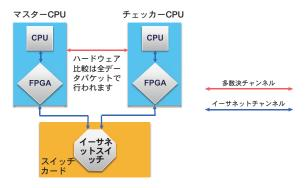
データファブリックのバウンドトランザクションの比較は、2002 多数決メカニズムにより行われ、2基のCPUに相違があると障害と判断され、CSCはフェイルセーフモードに入ります。フェイルセーフモードでは、全ての出力ポートはデフォルトでセーフ状態に入り、外部機器が誤った状態に設定される可能性を排除します。
