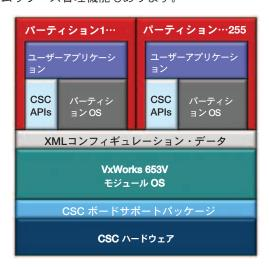
コアOSは、各パーティションへのCPUサイクル割当てとパーティションの実行順序を設定する静的に定義された構成表を使用し、パーティションスケジューラを実行します。コアOSはアプリケーションパーティションのために、システム時間・メモリを含む全共有リソースを制御します。コアOSはパーティション切り替え後に、アプリケーションパーティションが必要とするリソースを確保し、アプリケーション相互の破損を防止します。パーティション相互間、またパーティションとコアOS間の通信は、適切な通信チャンネルが使用された場合、及びシステム構成表でそのチャンネルが許可された時のみ実行されます。
