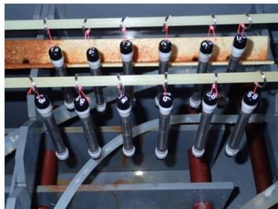
図 複合サイクル試験装置と試験片吊り下げ状態例
