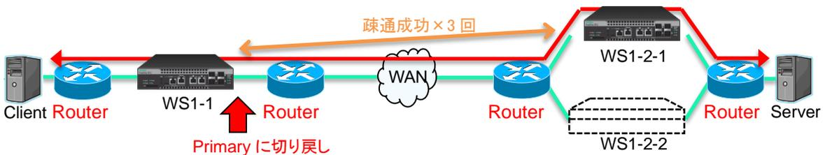
図 8.14.6-4 装置復旧時の切り戻し動作
