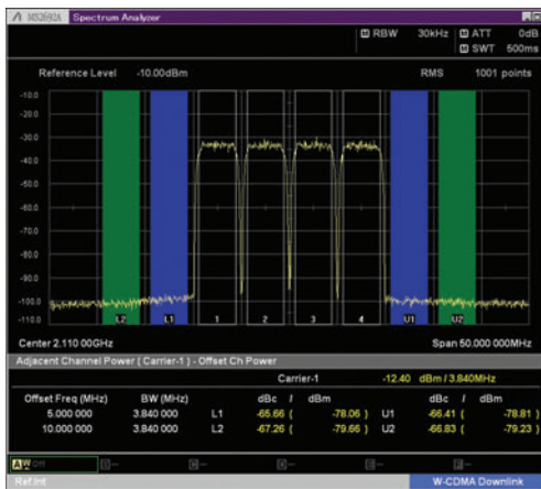
W-CDMA 4キャリアのACLR測定例 (TestModel1, 64DPCH x 4キャリア)
