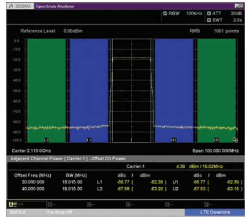
LTE FDD 1キャリアのACLR測定例 (E-TM1.1, 帯域幅 20MHz)
