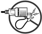
3. コンセントに接続するための緑色のアース線が AC 電源ケーブルに付いている場合、次の手順で金属製のアースコネクタをコンセントのアース端子に接続します(下図を参照)。
