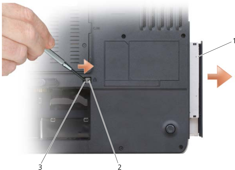
1 光学ドライブ 2 デバイス固定ネジ 3 切り込み
