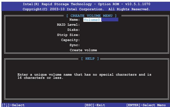
3. 「RAID Level」ではRAIDレベルを選択し、<Enter>で確定します。
