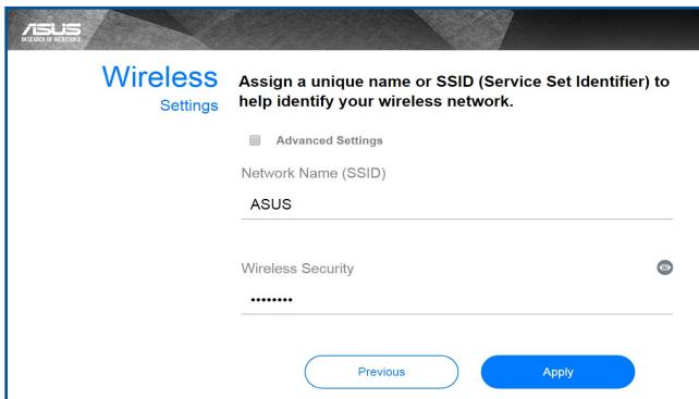
4. インターネットとワイヤレス通信の設定が表示されます。「次へ」をクリックし設定を完了します。
