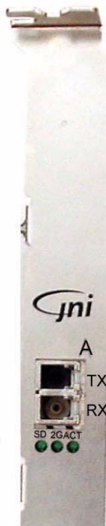
図 2-4 標準の SFF LC 光ファイバコネクタ (シングルチャネル HBA)
