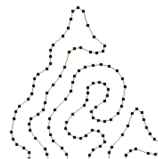
最小ステッチ長：0.4 mm コードギャップ：0.03 mm
