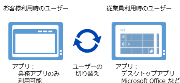
図 2.3-1 1 台を、組み込み端末として利用、Windows 8.1 として通常利用の切り替えが可能
