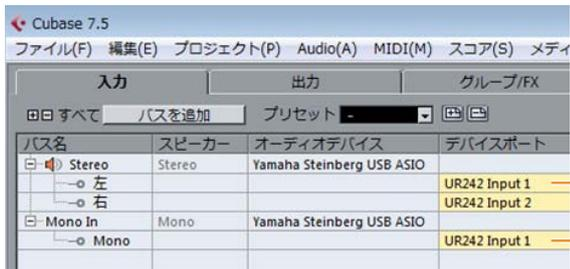
デバイスポートに同じ入力ポートが複数設定されている場合、上に表示されているバスのチャンネルだけに[HARDWARE]が表示されます。
