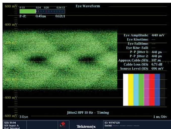
図54. 長いケーブルを使用した場合のアイ・パターン表示 (WFM7120型)
