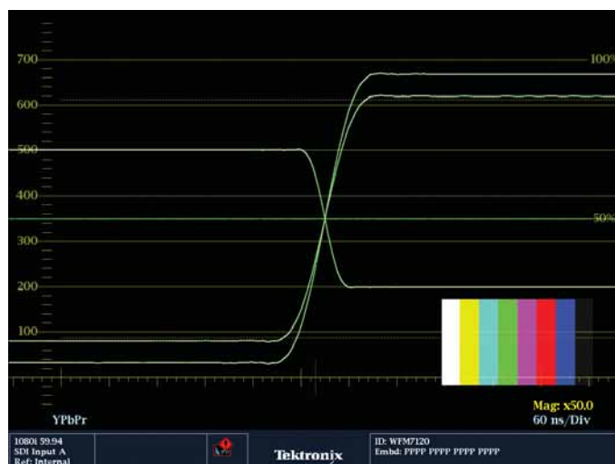
図67. 緑／マゼンタ変化点におけるチャンネル間のタイミング測定
