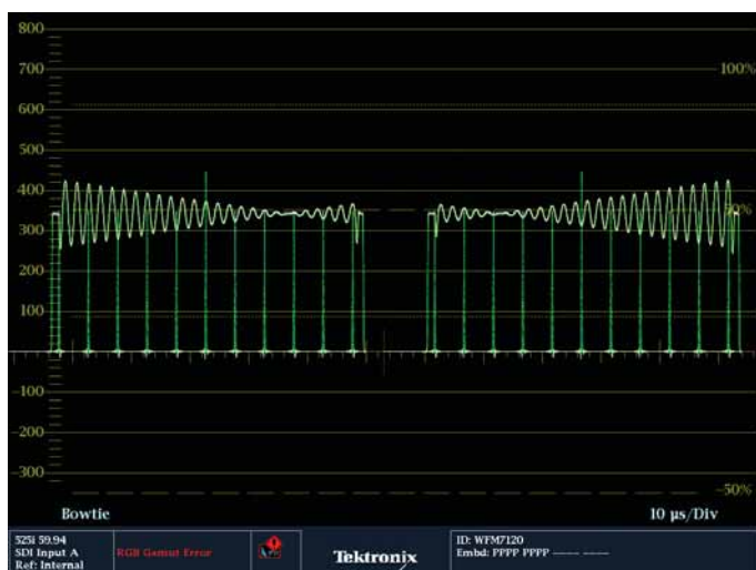
図71. ボータイ表示の例：Yに対して55ns遅延したPb、50ns先行したPr
