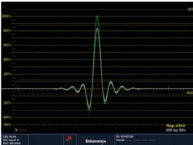
図28. 270Mbps EAVタイミング・リファレンス・パケットのアナログ・ルミネランス・チャンネル信号表示
