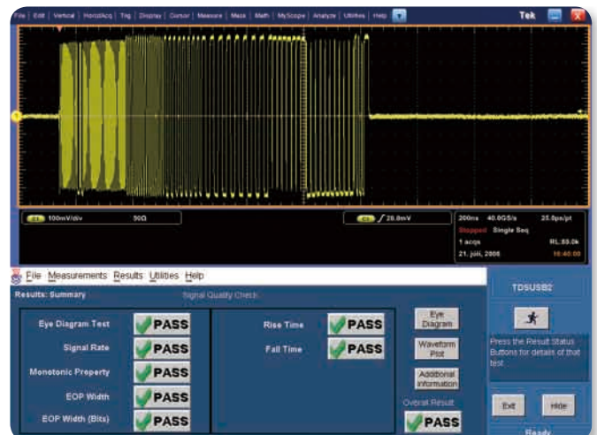
▶ 図3：TDSUSB2コンプライアンス・テスト・パッケージでは、測定結果が自動的に表示されます。
