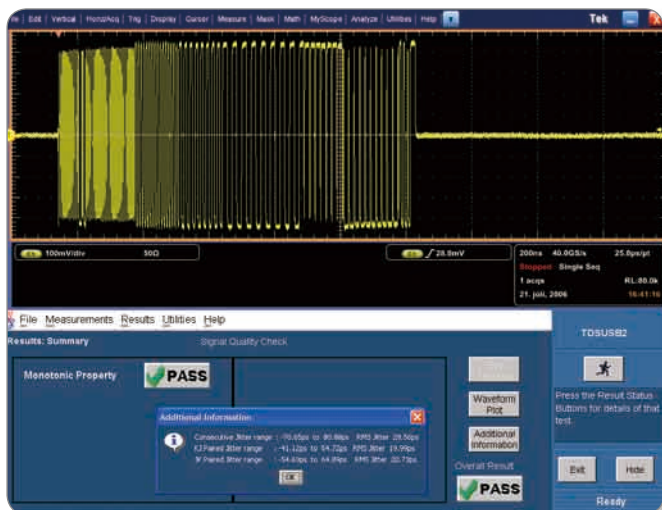
▶ 図8：TDSUSB2コンプライアンス・テスト・パッケージで取込んだテスト・パッケージから、各立上り／立下りエッジをチェックしたMonotonicityテストの例。
