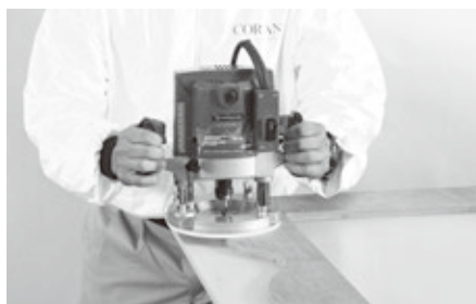
ルーター(テンプレートを使っての曲線切断)
