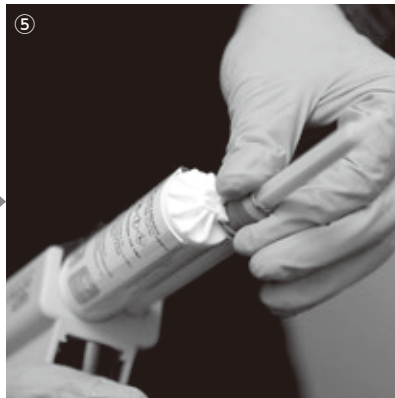
⑤ ミキサーチップを差し込み、時計方向に90度回して固定してください。
