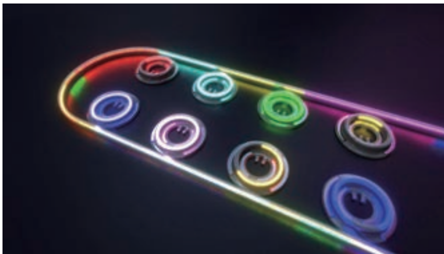
この8個のマイクロリング共振器と光導波路の図では、各共振器が特別な波長にチューニングされ、波長分割多重を可能にしている
