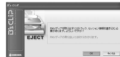
▲CD-MRWで、バックグラウンドフォーマットが終了していない場合
