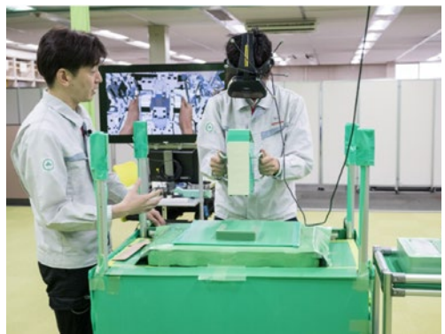
デジタル技術を使った作業シミュレーション。ヘッドマウントディスプレイを付けた作業者には、写真後方のモニター映像が見えている
