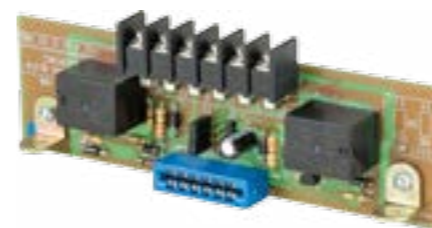
100-2 Two (2) ゾーンコントローラー基盤
