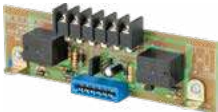
100-2 ゾーンコントローラー基盤
