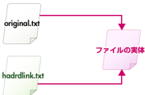
図 4：リンク先とハードリンクは同じファイルの実体を指す
