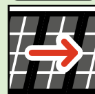
① パネル中心に水平に塗布する。
