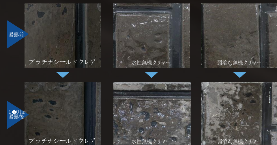
●実暴30年相当SUV1600hr 暴露後試験体比較写真
